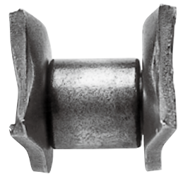
③옴셋 플레이트의 피로 옴셋 플레이트는 중앙에서 급힘 가공되어 있으므로 구부러진 부분의 응력 집중에 의해 피로 파괴를 일으킬 수 있다. 옴셋 연결구는 가능한 한 사용을 피한다.
