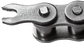
①정적 파괴 플레이트를 당겨서 파단 하중 이상의 하중을 가하면 플레이트는 신장된 후에 절단된다.
