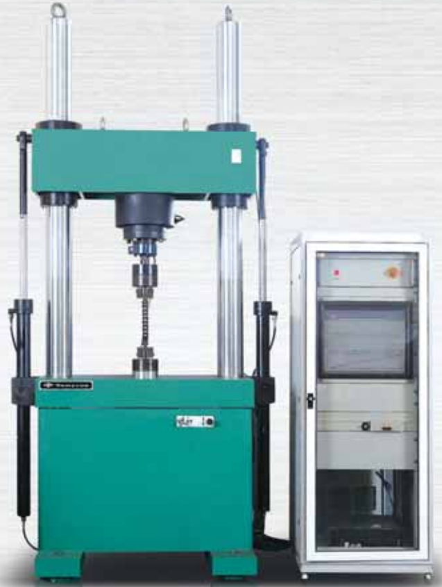
한국체인공업(주) 시험실내 피로시험기 Fatigue test equipment
